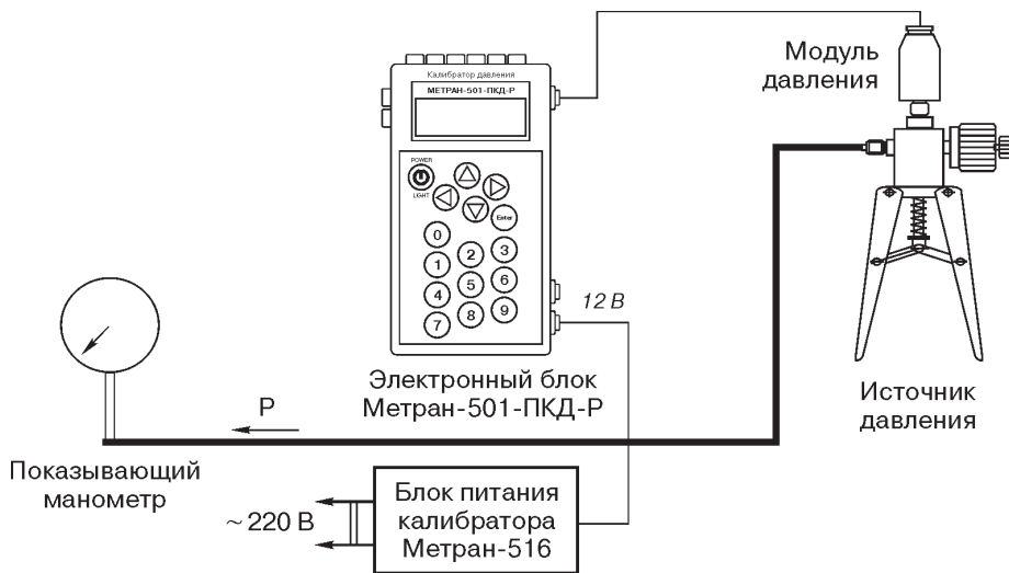
Рис. 5. Поверка и калибровка показывающих манометров.
